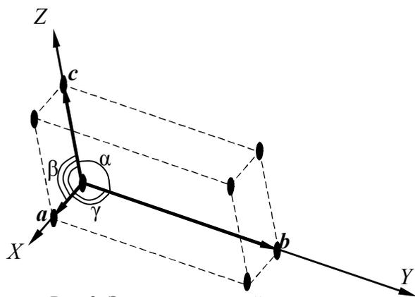
Рис. 3. Элементарная ячейка решетки
