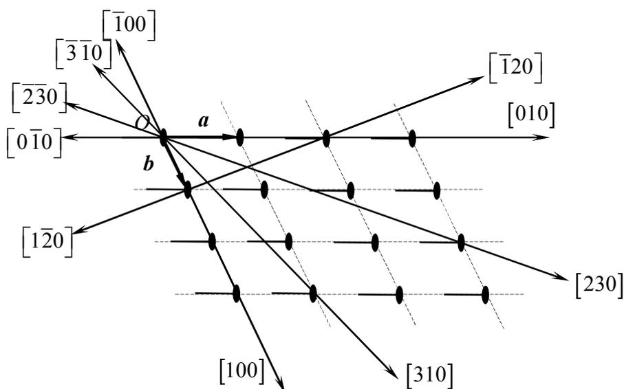
Рис. 6. Символы рядов плоской сетки, перпендикулярной кристаллографической оси Z
