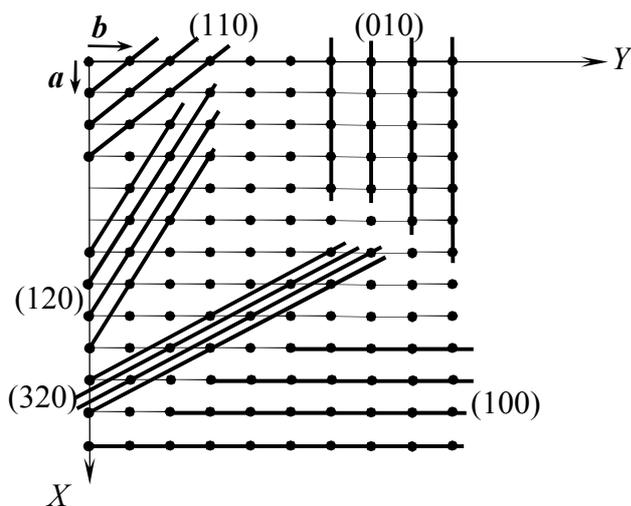
Рис. 10. Плоскости зоны  $\{001\}$  в кубическом кристалле
