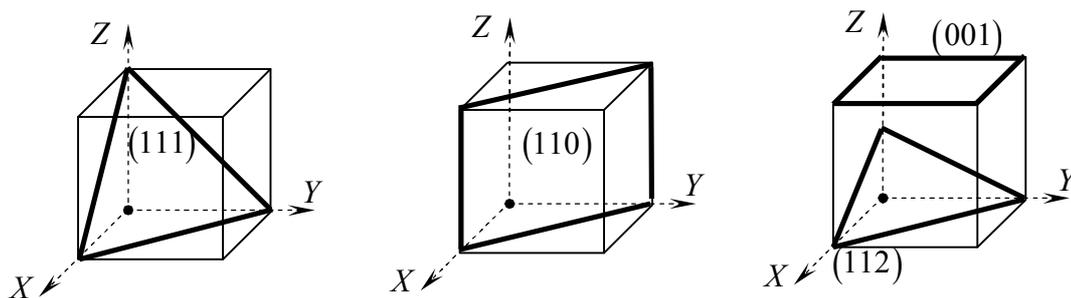
Рис. 9. Плоскости в кубических кристаллах
